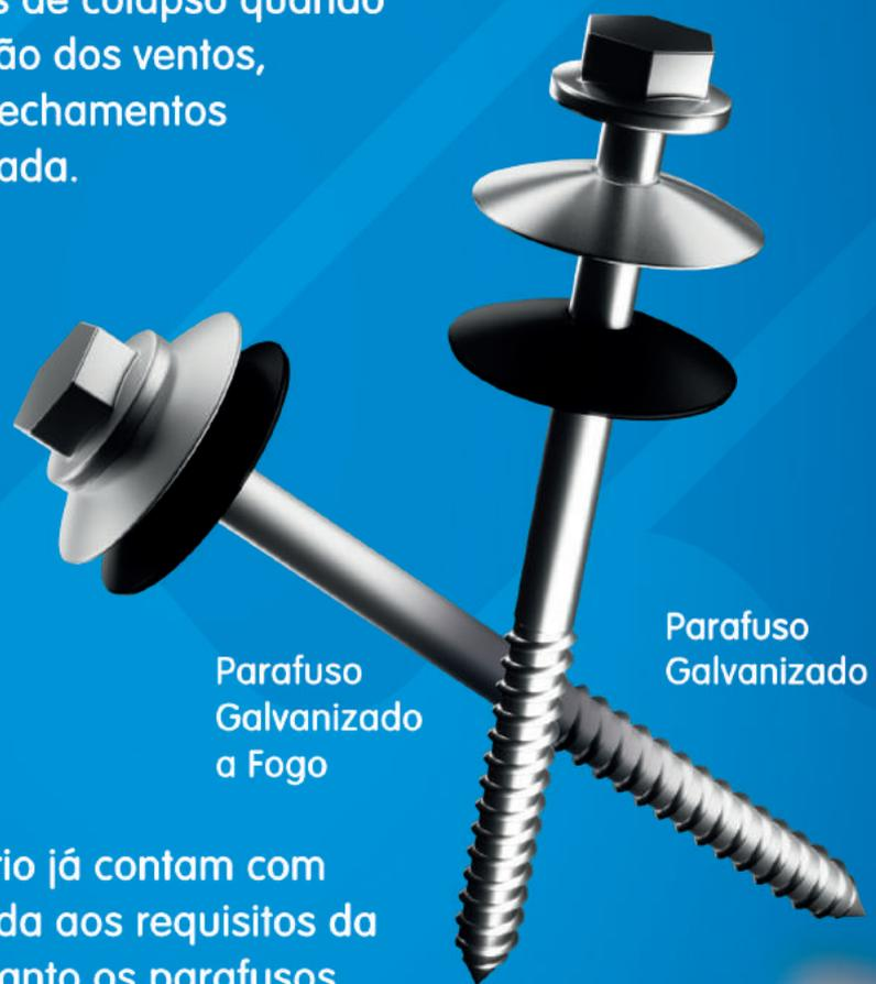
Os parafusos galvanizados a frio já contam com uma camada de zinco adequada aos requisitos da maioria das instalações, entretanto os parafusos galvanizados a fogo tem uma camada mais espessa e proporcionam maior proteção, sendo recomendados para instalações expostas à maresia ou outras intempéries mais agressivas.
